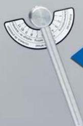
*Palanca de servicio para ajuste de altura del rodillo de presión*
